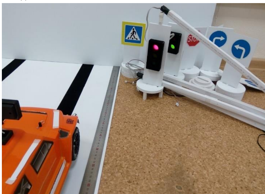
Рисунок. Полигон для тестирования системы технического зрения
