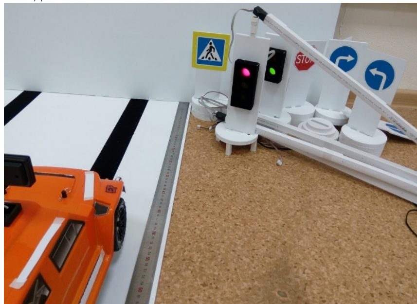
Рисунок. Полигон для тестирования системы технического зрения
