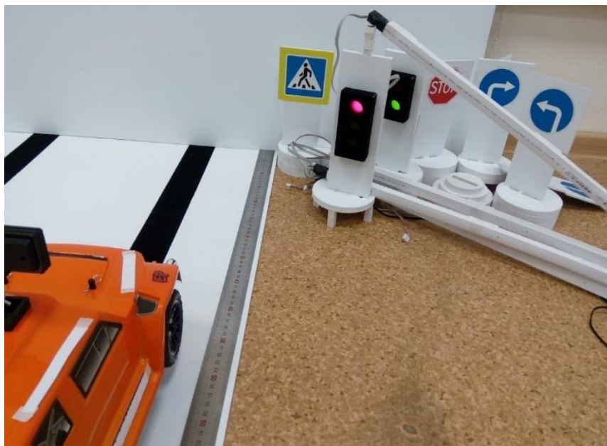
Рисунок. Полигон для тестирования системы технического зрения
